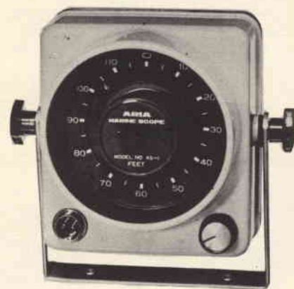
Fig. 2 - Eco scandaglio ultrasonoro PIONEER per piccole imbarcazioni e gommoni e per profondità fino a 45 m.
