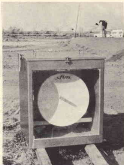
Fig. 13 - Fotografia di un tipico elemento radar, installato nel relativo involucro di protezione.
